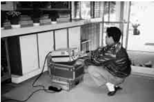
相關式漏水発見器による調査
